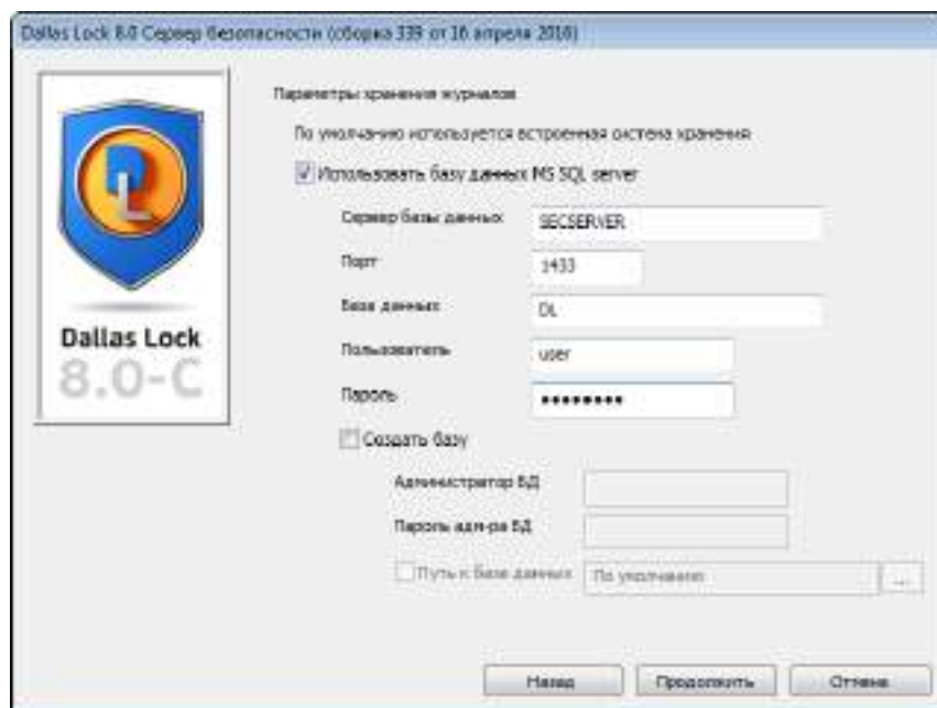
Рис. 34. Подключение к существующей БД в процессе установки СБ
