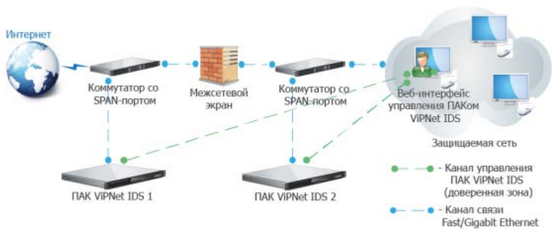
Рисунок 3. Подключение ViPNet IDS до и после межсетевого экрана
