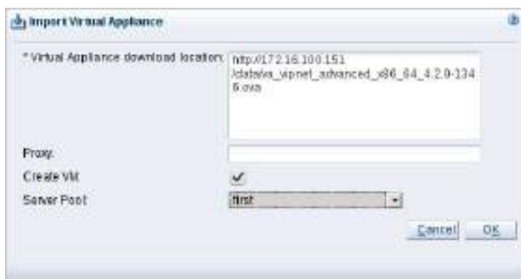
Рисунок 21. Задание пути к образу виртуальной машины
