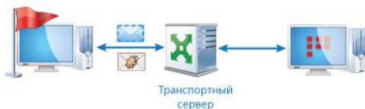
Рисунок 7. Роль транспортного сервера в сети ViPNet
