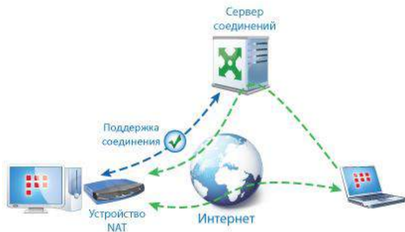
Рисунок 3. Организация соединений между сетевыми узлами ViPNet
