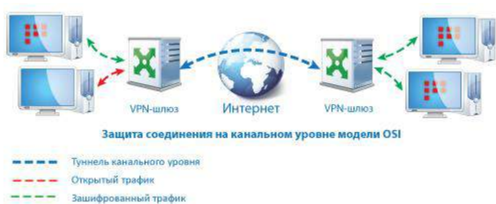
Рисунок 6. Защита соединения на канальном уровне модели OSI
