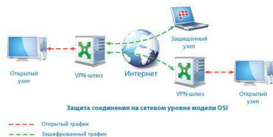
Рисунок 5. Защита соединения на сетевом уровне модели OSI
