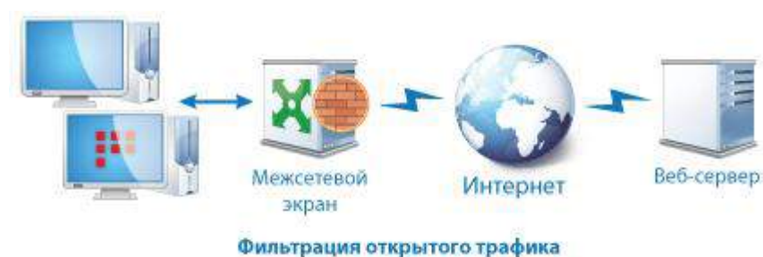
Рисунок 9. Роль межсетевого экрана в сети ViPNet
