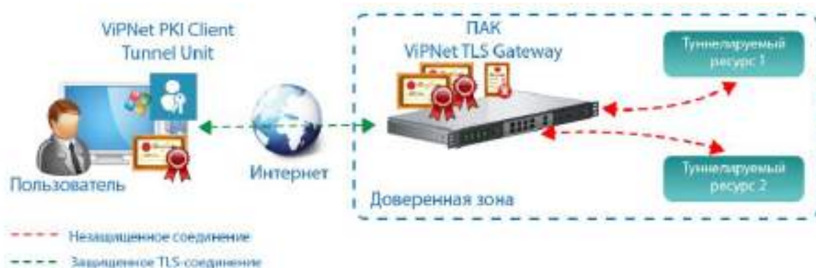
Рисунок 7. Установка соединения с туннелируемыми ресурсами
