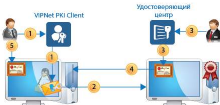
Рисунок 1. Передача пользователем запроса и получение сертификата
