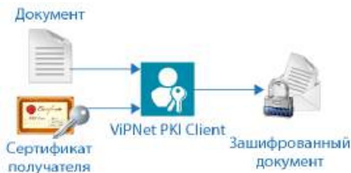
Рисунок 4. Шифрование документа с помощью программы File Unit
