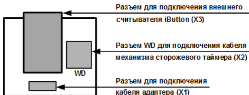
Рис.11 Расположение разъемов на адаптере для плат Mini PCI-E Half и PCI-E M.2 (вариант 3)
