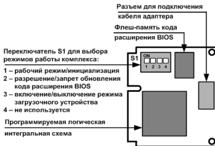
Рис.8 Расположение разъемов на плате Mini PCI-E Half
