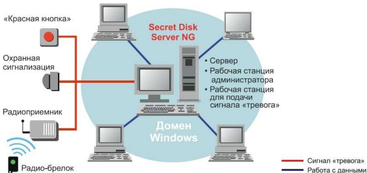
Рисунок 2 – Минимальная конфигурация установки SDS NG
