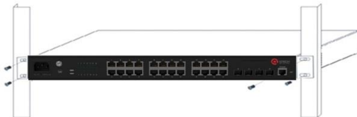
Установка коммутатора в стойку
