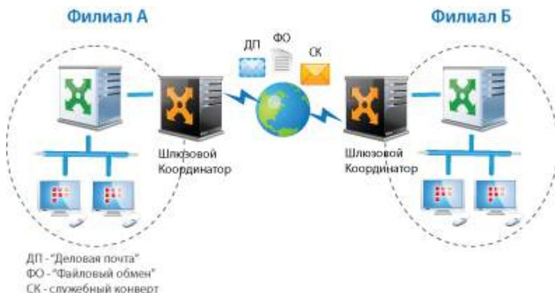
Рисунок 3: Обмен конвертами через шлюзовые координаторы
