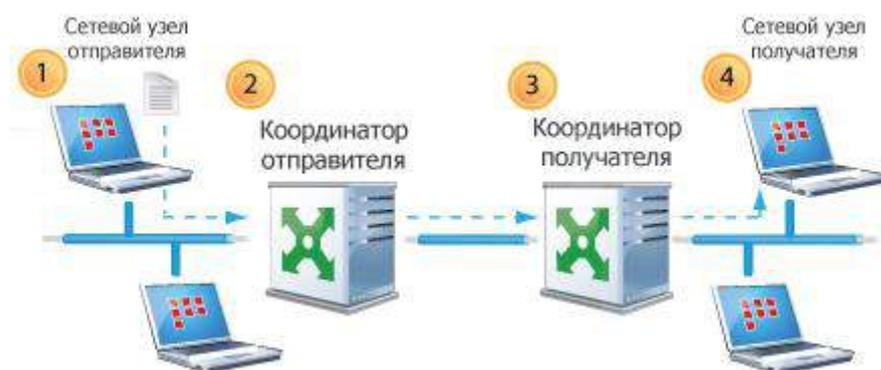
Рисунок 1. Передача конверта через свой координатор
