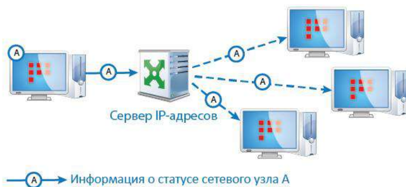
Рисунок 1. Сервер IP-адресов в сети ViPNet
