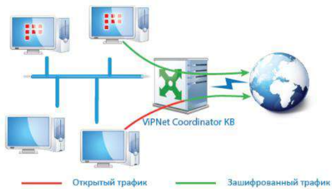
Рисунок 10. Подключение координатора без использования межсетевого экрана
