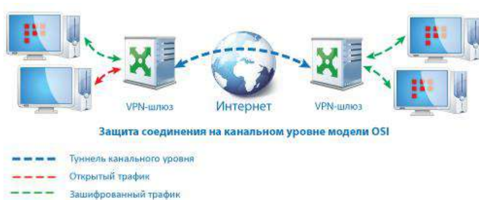
Рисунок 5. Защита соединения на канальном уровне модели OSI
