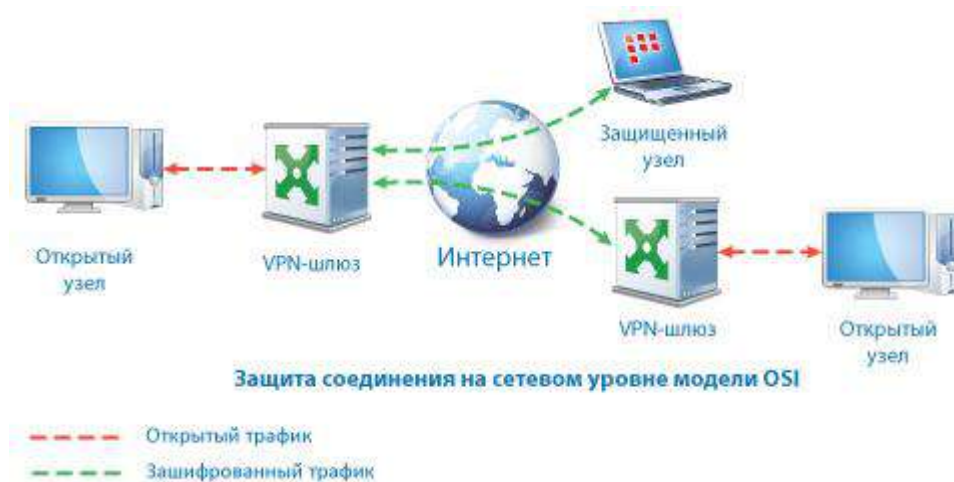
Рисунок 4. Защита соединения на сетевом уровне модели OSI
