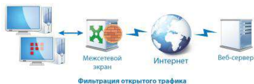
Рисунок 7. Роль межсетевого экрана в сети ViPNet
