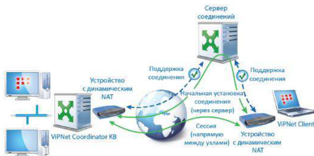
Рисунок 9. Подключение координатора через межсетевой экран с динамической трансляцией адресов
