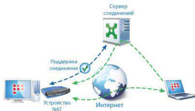
Рисунок 3. Организация соединений между сетевыми узлами ViPNet
