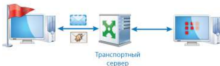
Рисунок 6. Роль транспортного сервера в сети ViPNet
