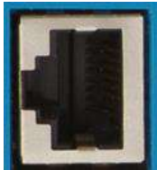
Рисунок 11. Разъем 8P8C для интерфейса Ethernet
