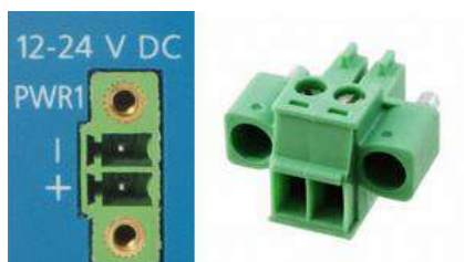
Рисунок 9. Разъем для подключения питания (слева) и клемма Phoenix Contact 1847055 (справа)
