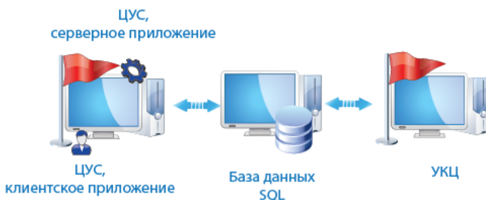
Рисунок 3. Установка серверного приложения ЦУСа и УКЦ на двух разных компьютерах
