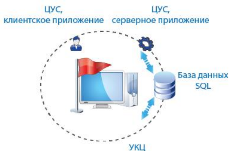
Рисунок 1. Установка серверного приложения ЦУСа и УКЦ на одном компьютере
