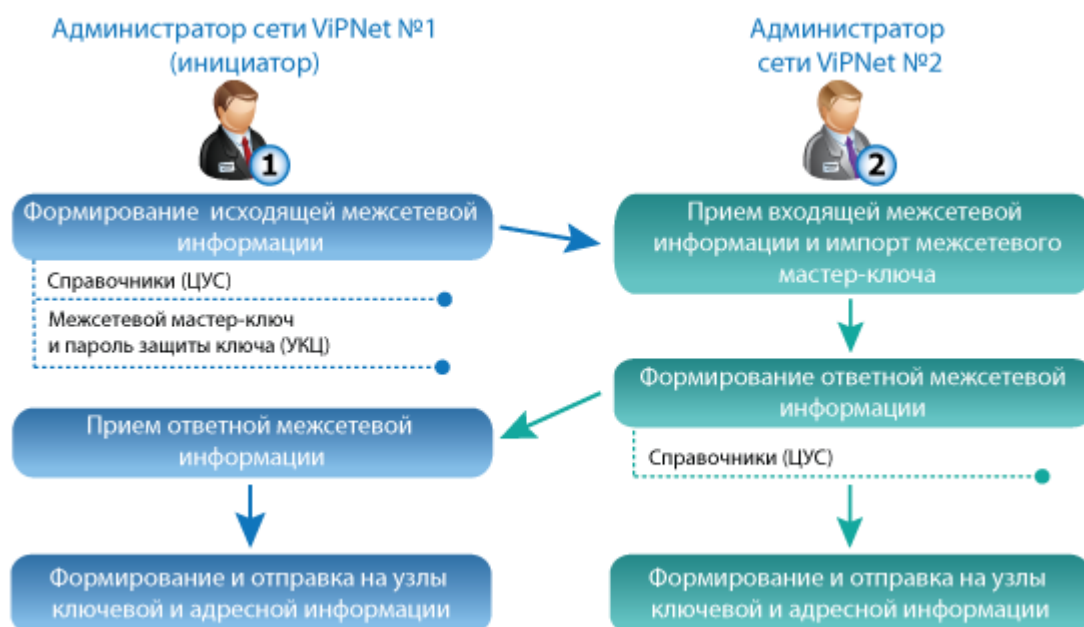
Рисунок 11. Схема настройки меж сетевого взаимодействия
