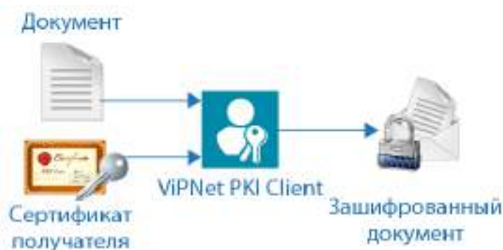
Рисунок 4. Шифрование документа с помощью программы File Unit
