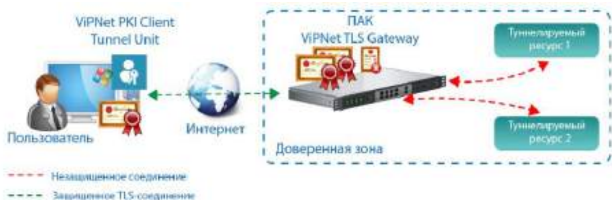
Рисунок 7. Установка соединения с туннелируемыми ресурсами
