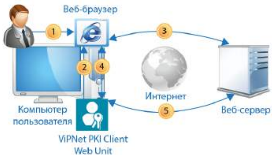
Рисунок 5. Использование электронной подписи и шифрования в веб-приложениях
