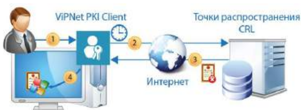
Рисунок 2. Процесс загрузки CRL с помощью ViPNet PKI Client
